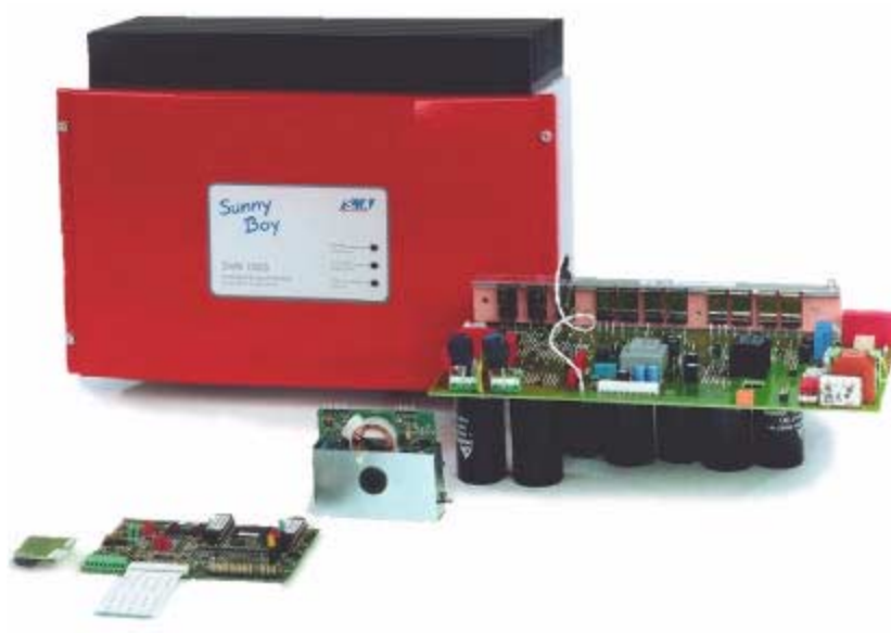
Abbildung 4: Der transformatorlose Sunny Boy 1500, Leistungsplatine, Regelungs- und Betriebsführungsplatine, Powerline-Modem und Fehlerstromsensor
